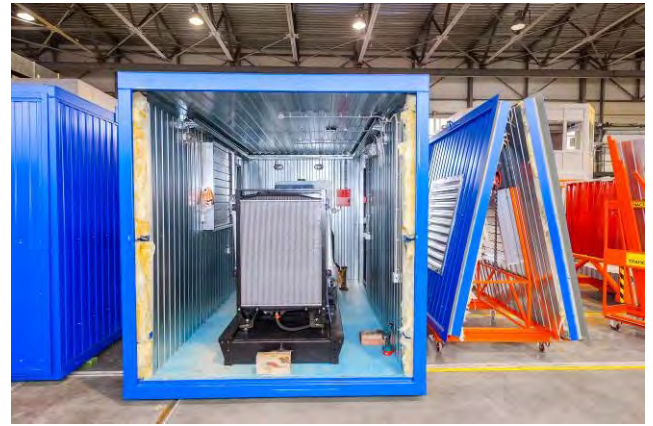
Быстроръёмная торцевая стена для удобства монтажа / демонтажа оборудования, ремонта ДЭС
